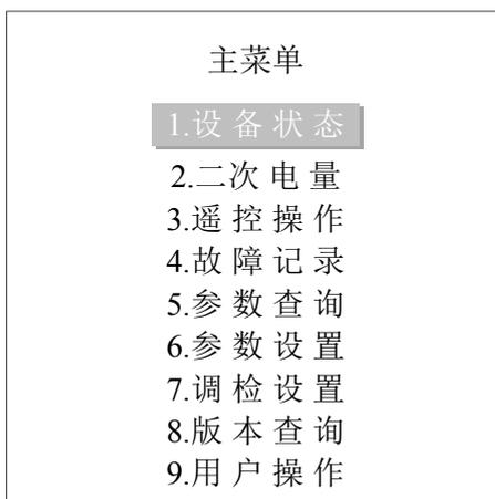
此时，按 ↑、↓ 键移动光标，按“确认”键进入相应的子菜单，如选择“设备状态”，进入遥信状态量显示界面。
